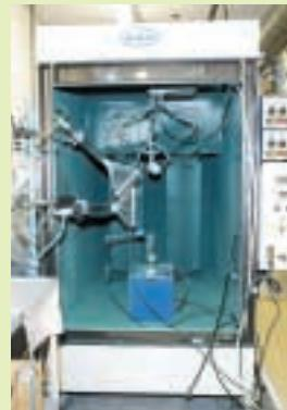
摩擦帯電方式を活用した粉体塗装設備
